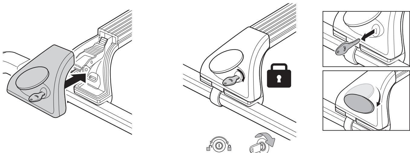
**SMONTAGGIO - DÉMONTAGE - DEMONTAGE - DISASSEMBLY - DESMONTAJE - DEMONTAŻ**
